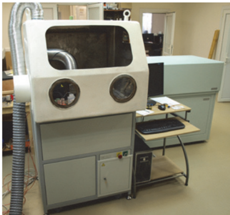
Рис. 98. Внешний вид защитного химического бокса с установленным внутри ИВС с МП и спектральным прибором «Гранд»
