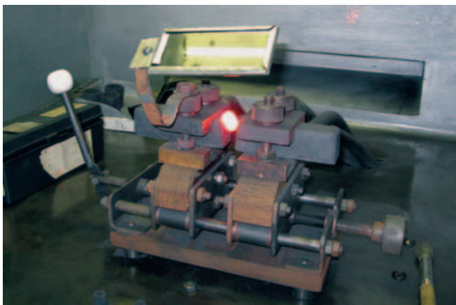
Печь сопротивления для сплавления золота в «королек»
