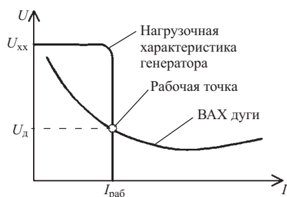
Рис. 1. Расположение рабочей точки дугового разряда
