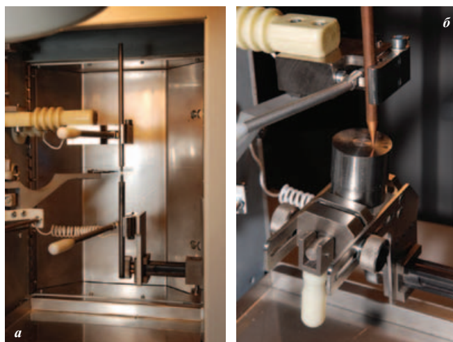
Рис. 2. Держатели электродов для стержневых (а) и компактных проб (б) в штативе
