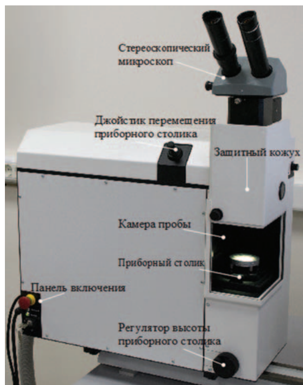
Рис. 3. Двухимпульсный лазерный источник возбуждения атомно-эмиссионных спектров
