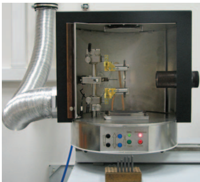
Рис. 1. Спектроаналитический штатив «Глобула»
