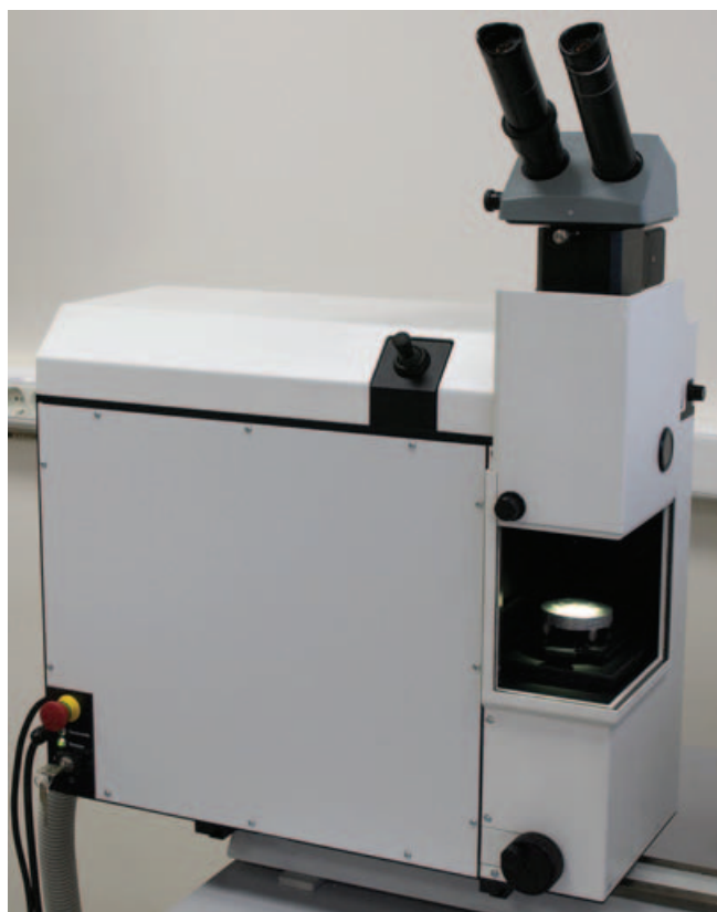
Рис. 2. Внешний вид лазерного источника возбуждения спектров
