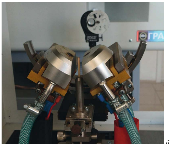
Рис. 1. Внешний вид горелок плазмотрона: первый (а) и второй (б) варианты
