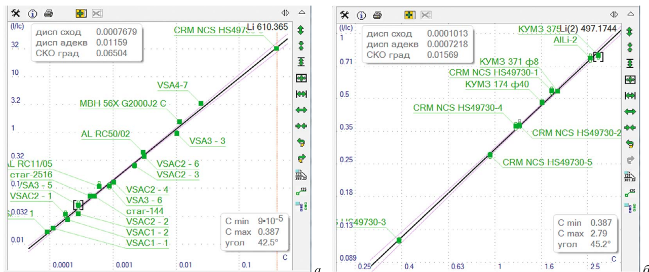
Рис. 6. Градуировочные графики для определения лития: а — при низких и средних содержаниях в алюминиевых сплавах по линии 610,365 нм; б — в сплавах Al-Li серии 14XX на втором этапе экспозиции по линии 497,174 нм
