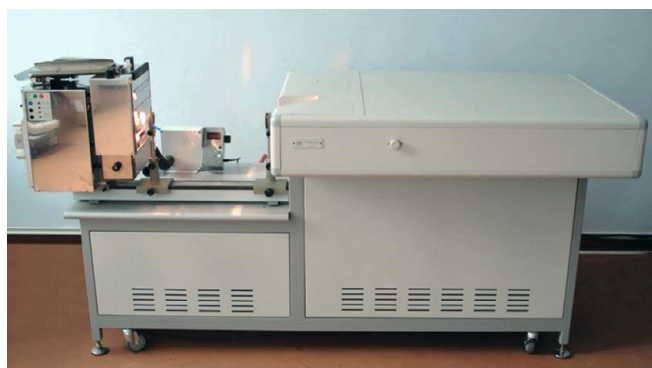
Рис. 1. Общий вид комплекса «Гранд-Поток» для анализа проб методом просыпки-вдувания
