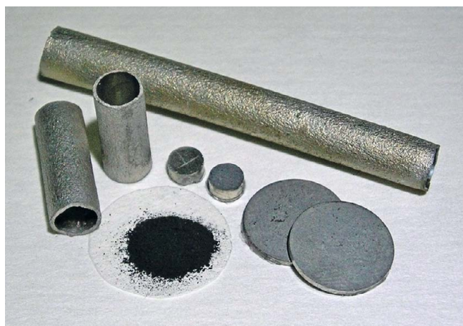
Рис. 1. Внешний вид исходного НП иридия и изделий из него (трубок, дисков), изготовленных магнитно-импульсным прессованием
